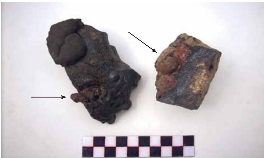
03 Unterschiedliche Ausbildungsformen, entstanden durch Temperaturschwankungen im Ofen. Links: unregelmässige; rechts: kugelförmige Gebilde. Beim Verhüttungsprozess im 15./16. Jh. blieben diese aufgeschmolzenen Metallklümpchen in der Schlacke hängen. Fundort: Erezsäss ob Serneus.
