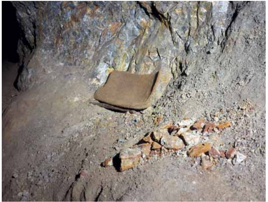
21 Kleiner, halber Erztrög in einem Abbaugesenk. Neben dem Erztrög liegt ein noch intakter Ersatz-Bergeisenstiel; im Vordergrund gesammeltes Eisenerz. (Bild Luisa Karrer)
