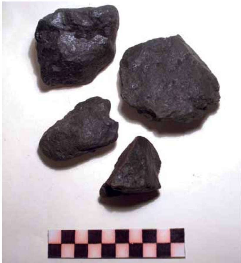
01 Schwarzes, metallisch glänzendes Manganerz aus dem Landquart-Geröll bei Serneus. Mit einem herkömmlichen Magneten ist kein Magnetismus feststellbar. Anders sieht es mit einem Neodym-Magneten aus. Bei diesem sind auch Rhodochrosit und Braunit schwach bis mittelstark magnetisch. Massstab 10 cm.
