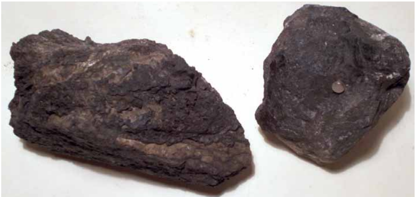
10 Schwarze Vererzungen sedimentären Ursprungs. Links: Eisen- und Manganerz in Tonschiefer (Länge 14 cm, abfärbend), rechts in Siderit (=kristallin, nicht abfärbend). Beide Stücke sind stellenweise magnetisch (Knopf-Magnet = Neodym). Fundort: Aus dem Stützbach-Geröll bei Oberlaret.
