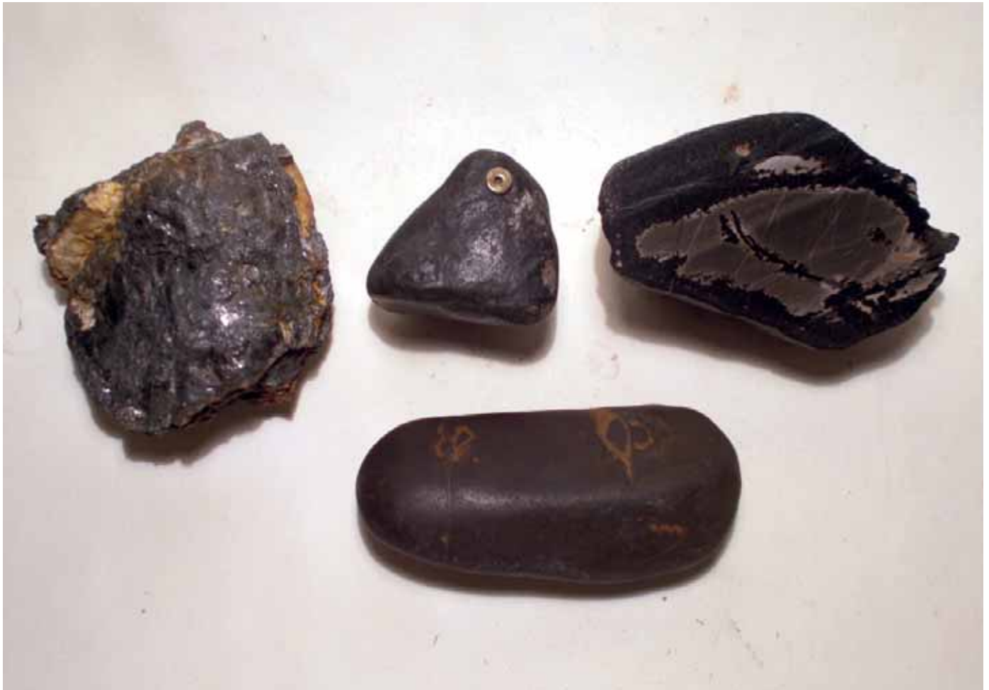
09 Eine Auswahl an verschiedenen schwarzen Vererzungen: V.l.n.r. nicht magnetisches Tirolerloch-Erz vom Inner Chinntobel/Monbiel; magnetisches Nugget, vermutlich Braunit und/oder Magnetit (Knopf = Neodym-Magnet) aus dem Landquart-Geröll bei Serneus; verwitterter schwarzer Rhodochrosit mit grauem Sideritkern, nicht magnetisch; vorne ein schwach Fe- und Mn-haltiger Tonschiefer mit Limonit (Länge 9 cm), nicht magnetisch. Beide Stücke stammen aus dem Landquart-Geröll bei Klosters-Gulfia.
