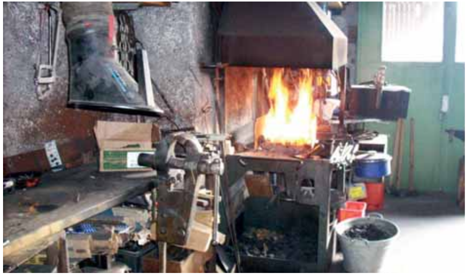
04 Das Einfeuern der Esse mit Koks und Anthrazit. Bei der Verbrennung von Anthrazit erzielt man höhere Heizwerte bei niedrigeren Emissionswerten (rauchfreies Feuer). Anthrazit ist selten, begehrt und dementsprechend teurer als Kohle oder Koks.
