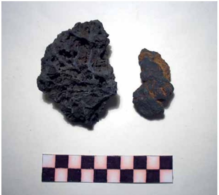
08 Schwammartiges Manganerz mit zahlreichen Hohlräumen. Daneben ein kleineres Stück mit fast erdigem, gelbem Goethit/Limonit. Fundort: Aus der Geröllhalde unterhalb der Erzgrube St. Jakob auf Casanna (ca. 2200 m ü. M)
