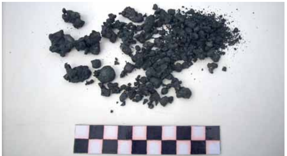
06 Aufgeschmolzenes Eisen-Mangan-Gemisch mit hohem Ferromagnetismus. Vereinzelt verbanden sich die kleinen Körnchen zu grösseren Klümpchen, bevor die Hitze ein Loch in den Gusseisentiegel brannte.
